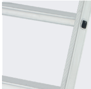
Geriffelte rutschfeste, an die Holme gebördelte 80 mm-Tritte
