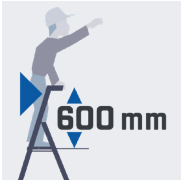
Maximale Kippsicherheit nach vorne
