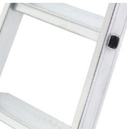
Peldaños estriados 80 mm antideslizantes, engastados en los montantes
