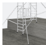
Pour travailler en décalage de niveau
