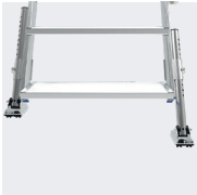
Patas articuladas, ajustables cada 20 mm sobre 230 mm
