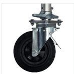
Ruedas Ø200 mm con bloqueo ajustables sobre 175 mm cada 12,5 mm
