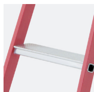
Enlace engastado cuadrado, sin tornillo ni remache. Peldaño de 80 mm de ancho
