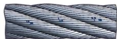
fils cassés au niveau des "parures"
