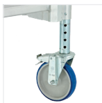
Räder Ø 150 mm individuelle Einstellung alle 25 mm auf 125 mm
