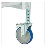
Ruedas Ø150 mm con ajuste individual cada 25 mm sobre 125 mm
