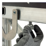
Sistema de bloqueio dos rodapés
